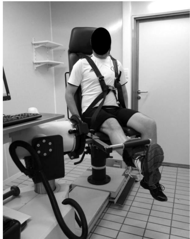
Fig. 1 – Isokinetic dynamometer.
